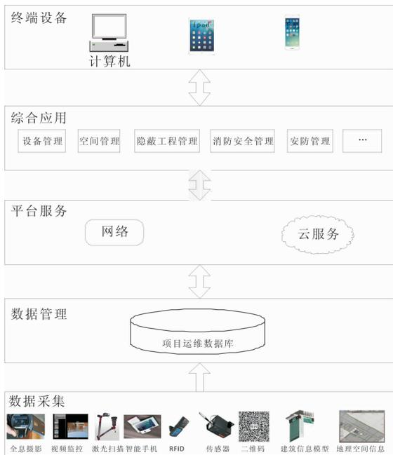
图3 基于BIM技术的项目运维管理系统框架
